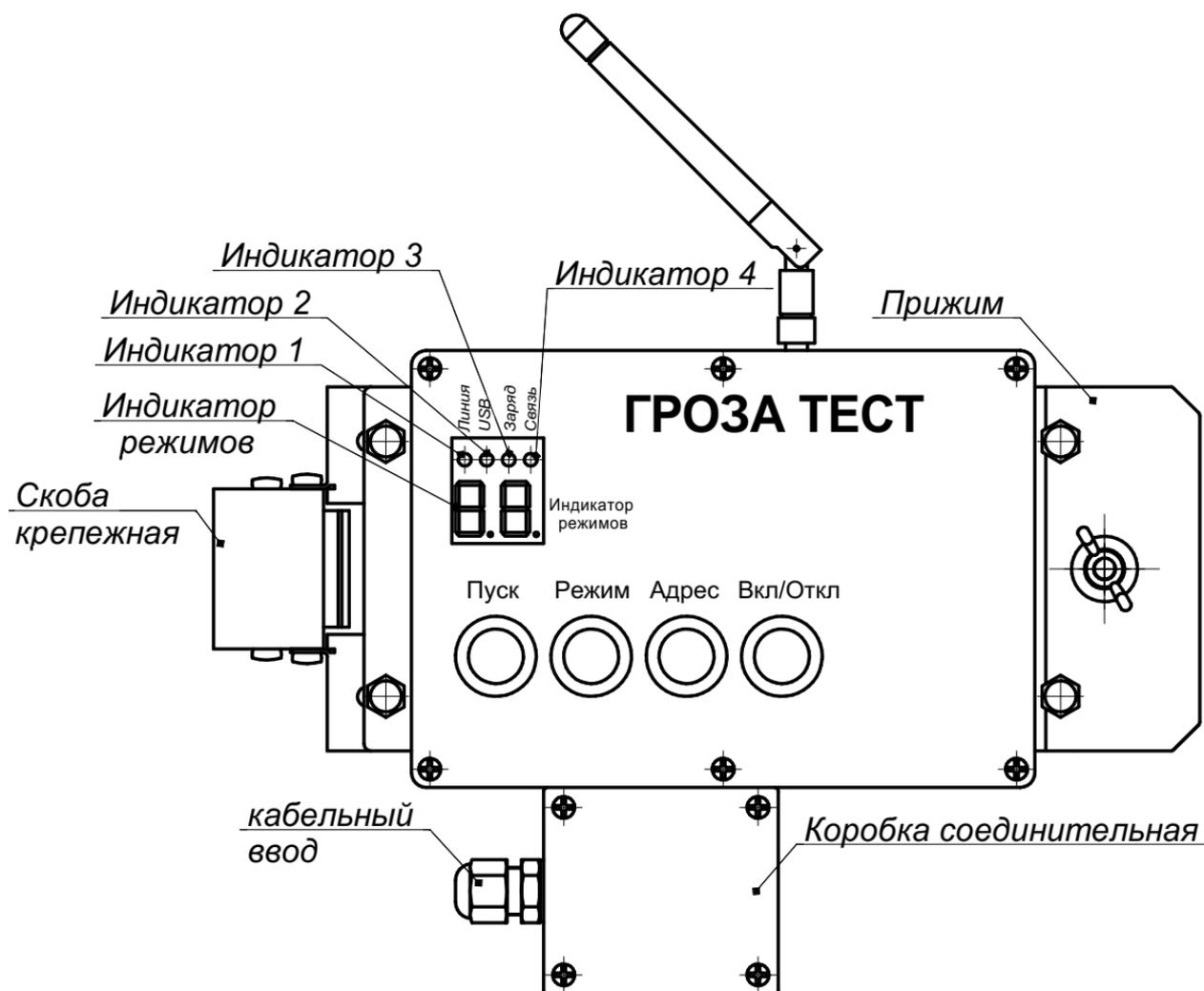
Рис.1 Блок электронный.
