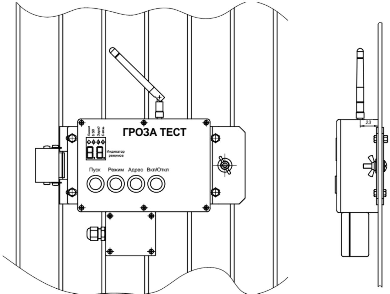
Рис.4 Монтаж изделия на ограждение.
