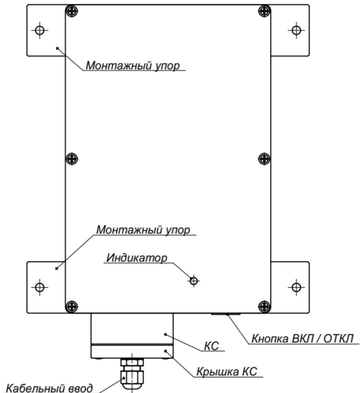
Рис.1 Блок электронный.
