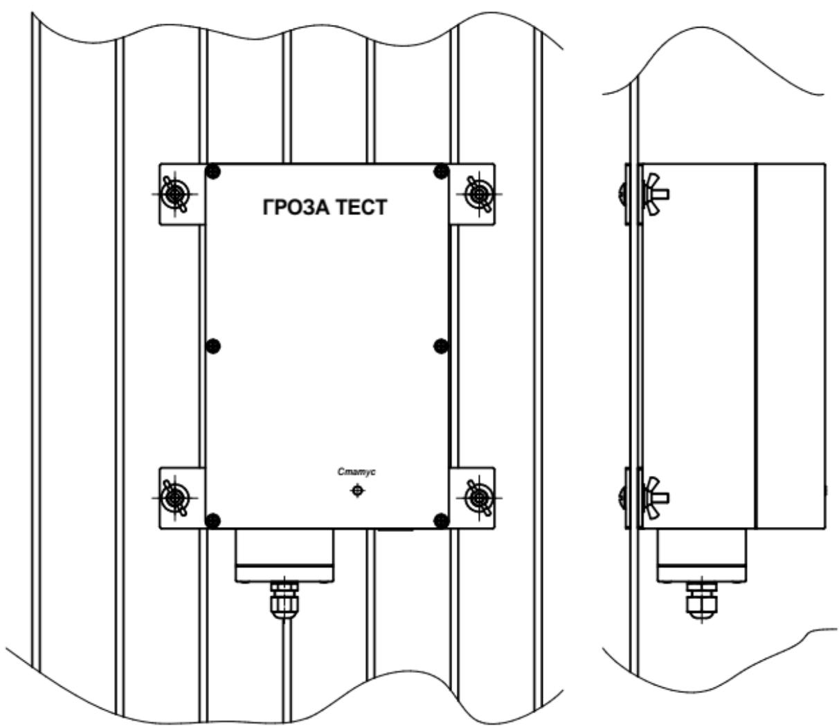
Рис.4 Монтаж изделия на ограждение.
